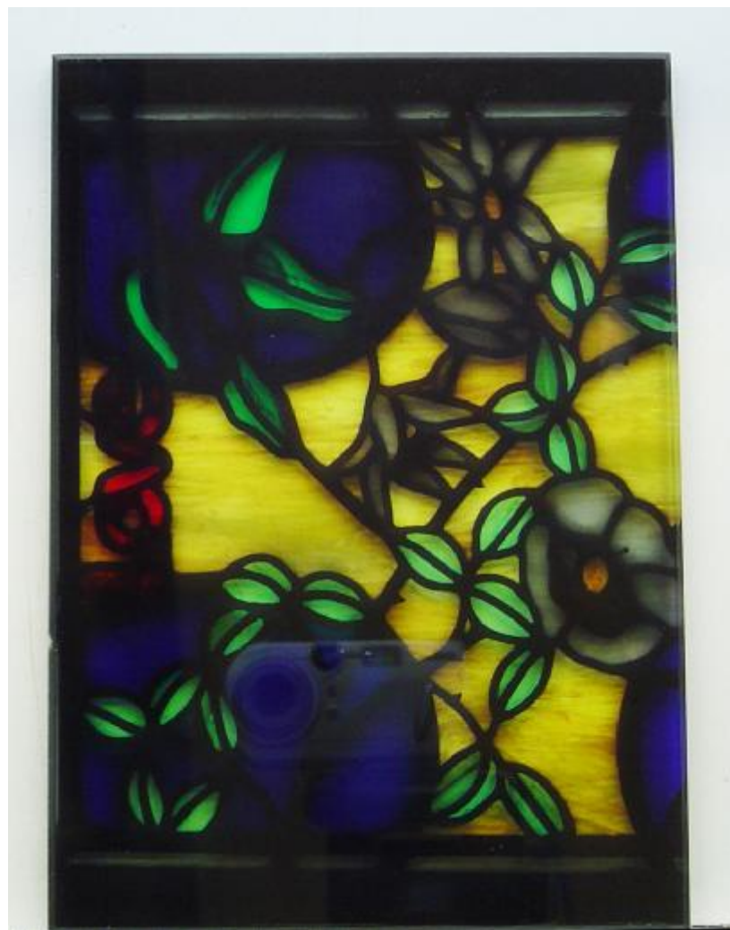
Figuur 2.1 Decoratief paneel (09-0066-1) na 6000 uur expositie in de Weather-Ometer ci 4000.
